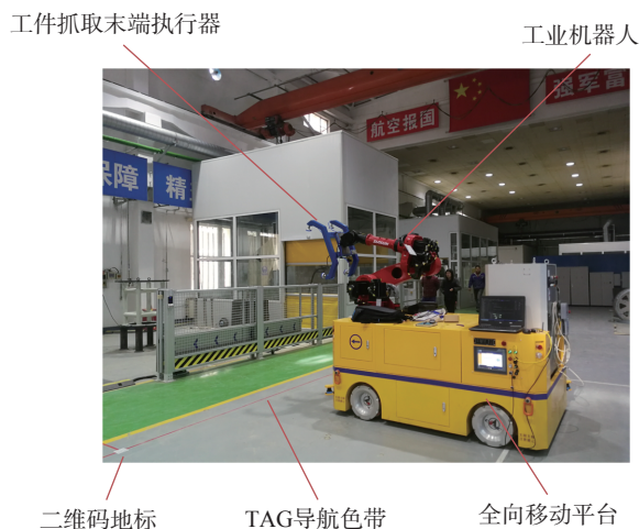
图6 物流配送CPS单元构成
